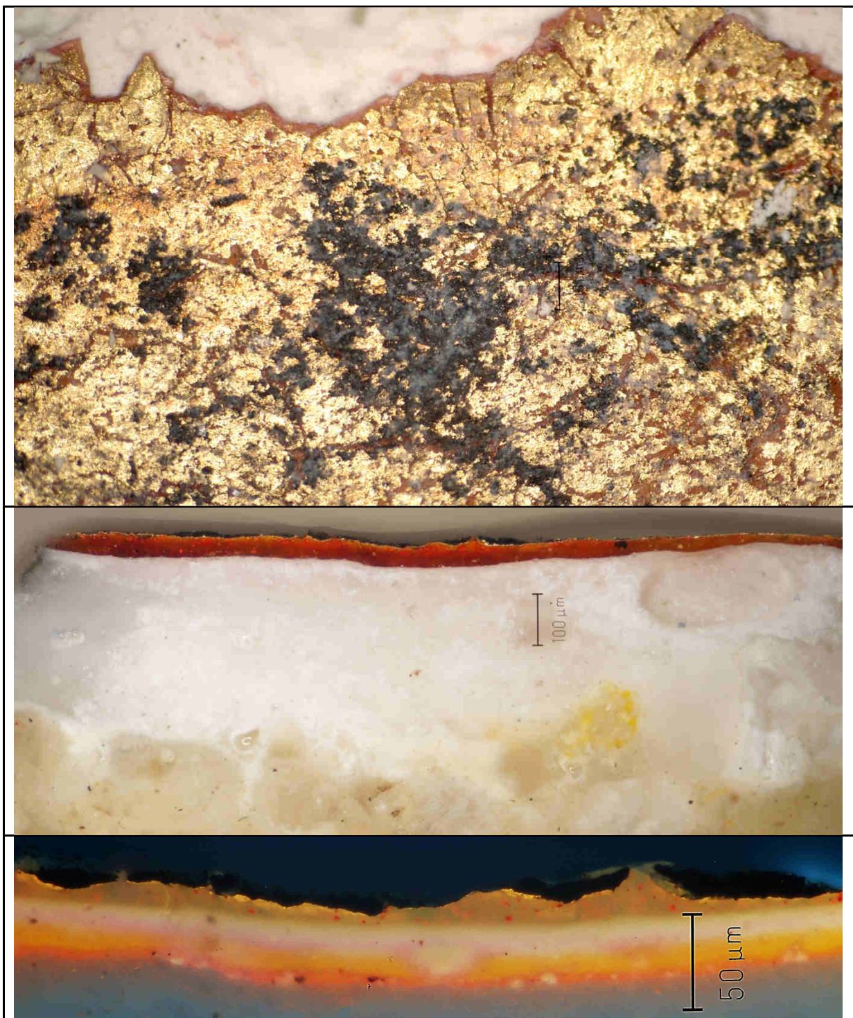
Abb. 6: MPIII.10. Vergoldung auf einer rötlichen Anlegesicht. Auf der Metalloberfläche sind lokal ein transparentes Harz und grauschwarze Partikel angereichert.
